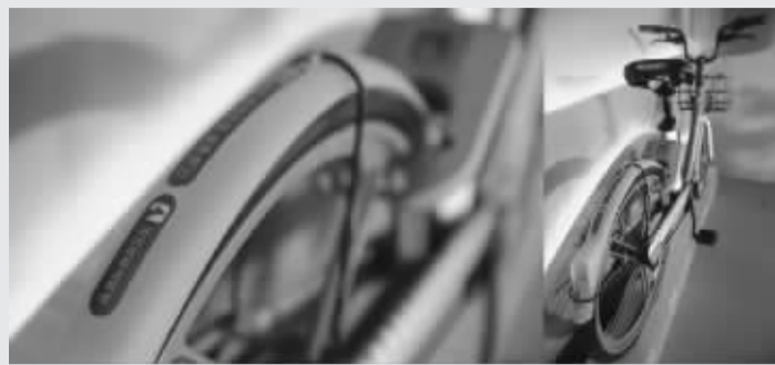
由外卖餐盒循环再生后制作的摩拜单车挡泥板
